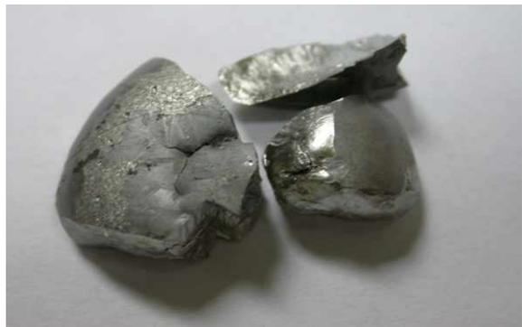
Botón de aleación formadora de hidruro, elaborado en horno de fusión por arco eléctrico.
