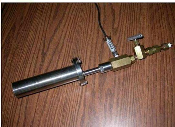
Almacenador de hidrógeno a base de hidruros.
