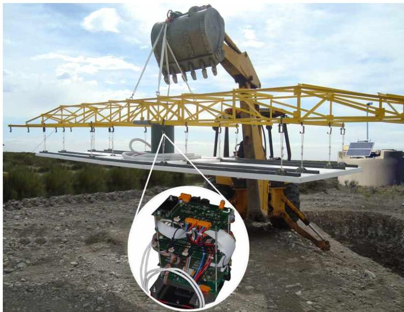
Fig. 2 - Momento en el cual se entierra en el Observatorio el primer contador de muones. En el inserto se ve la electrónica del mismo.
