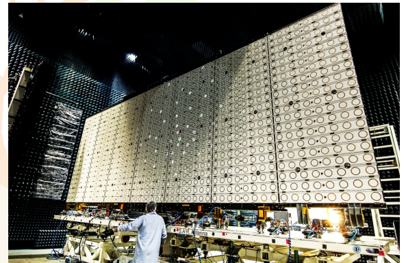
Fig. 1 - Antena SAR del satélite SAOCOM-1B durante los ensayos mecánicos en el Laboratorio de Integración y Ensayos del Centro Espacial Teófilo Tabanera, en la provincia de Córdoba. (Fuente Prensa CONAE)
