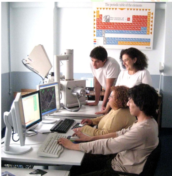
Fig. 1 - Microscopio Electrónico de Barrido FEI QUANTA 200 instalado en el Laboratorio de Microscopía Electrónica de la Unidad de Actividad Materiales de la CNEA.
