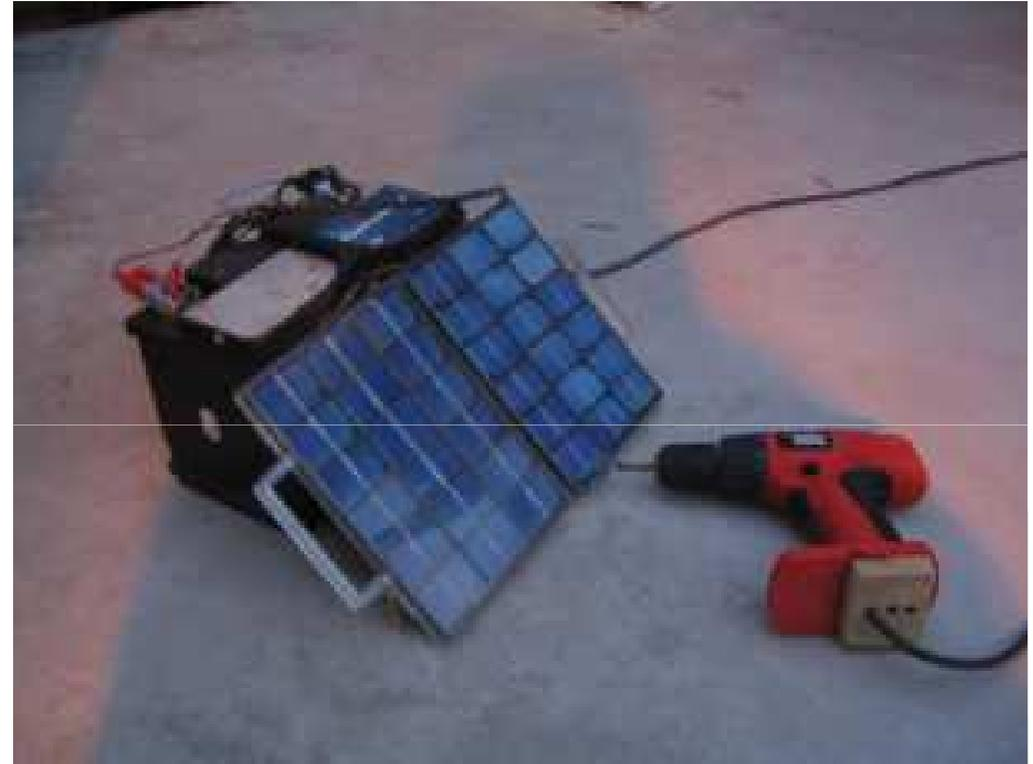
Toda la construcción utilizó mayoritariamente tornillos y tirafondos de diversas medidas. La principal herramienta fue una atornilladora de 12V alimentada por una batería de 70Ah cargada con un panel solar FV plegable.
