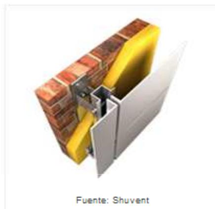
Un sistema con fachada ventilada, está formado por un aislamiento rígido o semirrígido, generalmente lana mineral, fijado a la fachada existente, y una hoja de protección (formada por vidrios, bandejas, composite, etc) separada del aislamiento, formando una **cámara por donde circula el aire** por simple convección. La hoja de protección se fija al muro soporte mediante subestructuras diseñadas al efecto.
